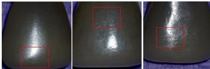
Рисунок 4 – Поля зрения для оценки поверхностной структуры образцов
